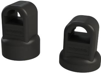
A guia do Varão redondo 8mm (A) tem uma porca M6 fundida no corpo. para montagem com parafuso soldado (Stud) ou parafuso normal. O formato do recorte permite que a parte chata do varão passe por dentro da guia.
